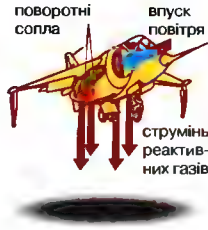
Літак вертикального зльоту і приземлення
